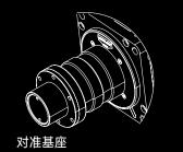
连接基座时,将方向盘插入基座并按下对频按键进行连接
