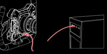
如对频无响应, 使用附带的USB Type-c线缆接入方向盘背后的接口与PC连接 使用SimPro Manager同步方向盘频道 (使用无线模式游玩前请拔下线缆)
